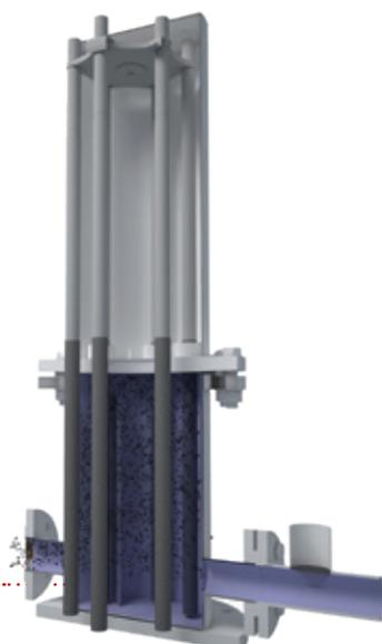
L'air comprimé sort les noyaux des tubes et les robinets de vidange sont enclenchés. Les contaminants sont relâchés et évacués.
