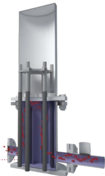
Dual Flow Technology™ garantit une durée d'exposition maximale du liquide aux aimants à haute intensité, ce qui permet d'éliminer pratiquement 100 % de la contamination ferreuse dès le premier passage.
